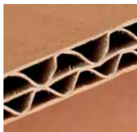
Двухслойный гофр для грузов от среднего веса до тяжелых
