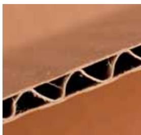
Однослойный гофр для обычных легких грузов
