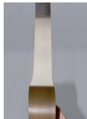
Стандартная ПП-лента вытягивается до разрыва
